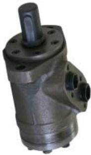
Les moteurs SMR ont une capacité de couple élevé à basse vitesse. Ils convertissent l'énergie hydraulique en énergie mécanique. Ces moteurs compacts et économiques sont disponibles avec des cylindrées allant de 50cm<sup>3</sup> à 400cm<sup>3</sup>/tour.
