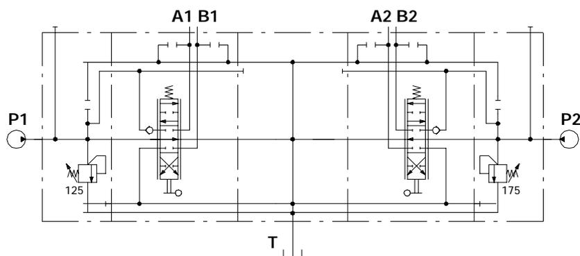
Esempio di descrizione: SD25/1/AC(XG-125)/18L/CS3/18L/BC(YG3-175)/SD16/1
