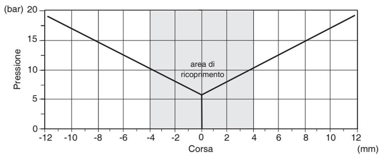
**Curva di controllo sulle bocche VA e VB: tipo 033**
