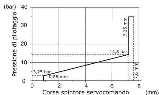
**Curva di controllo sulla posizione 2 e flottante: tipo 0096**
